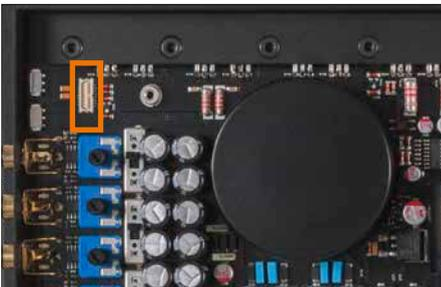
6. Stecken Sie die mitgelieferte Inbusschraube in die vorgesehene Befestigungsöffnung des HDM 2 Moduls und fixieren Sie diese sorgfältig.
