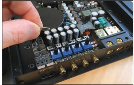
7. Befestigen Sie das neue, dem HDM 2 beiliegende Seitenblech mit den Inbusschrauben. Im Anschluss montieren Sie wieder die Acrylabdeckung.
